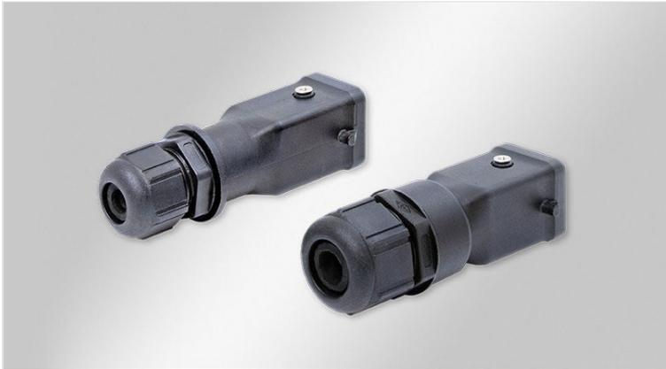
Für die teilbare Kabeleinführung MIS und die Adaptertülle AT-HA bietet icotek Einsatzsets 3A und 4A sowie passende Steckergehäuse an, wahlweise mit M20 Kabelverschraubungen für Kabeldurchmesser von 6 - 12 mm oder M25 Kabelverschraubungen für Kabeldurchmesser von 13 - 18 mm.
